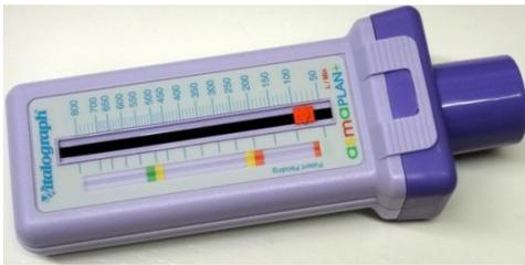
Peak-Flow-Meter sind einfache Lungenfunktions-messgeräte, die wie eine Federwaage konstruiert sind: Durch den Atemstoß, der auf eine Platte trifft, wird eine Feder zusammengedrückt. Je stärker der Atemstoß, um so weiter wird die Feder zusammen-gedrückt. Mit der Platte wird ein kleiner Zeiger auf der Skala vorgeschoben, der die maximale Atemgeschwindigkeit (peak-flow) anzeigt.
